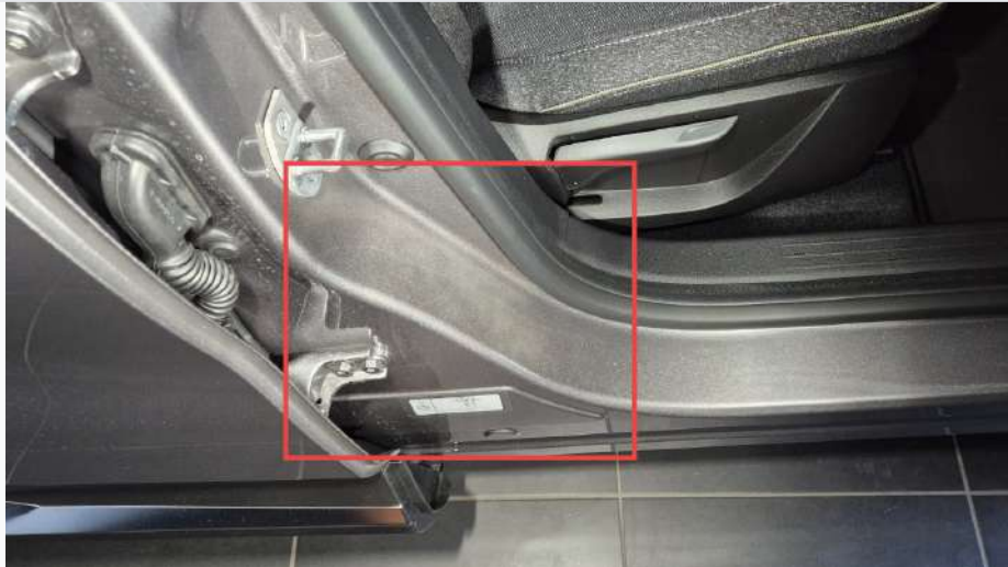
Przebarwienie we wnęce prawych przednich drzwi
