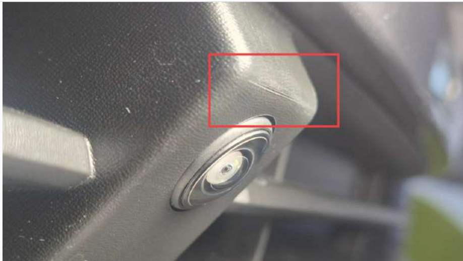
Zarysowanie na obudowie przedniej kamery
