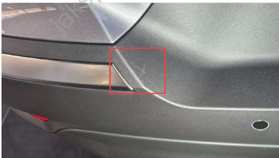
Zarysowanie na tylnym zderzaku
